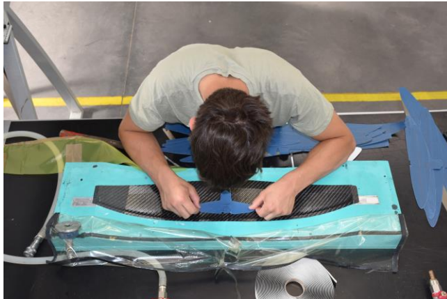
Dépose de plis préimprégné en fibres de carbone
